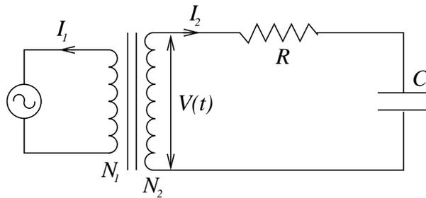
O enrolamento primário do transformador contém  $N_1 = 200$  espiras, enquanto o secundário tem  $N_2 = 1000$  espiras. A tensão obtida no ramo secundário é dada por  $V(t) = V_M \text{sen}(\omega t)$ . As respostas devem ser dadas como função de  $\omega$ ,  $R$ ,  $C$  e  $V_M$ .
